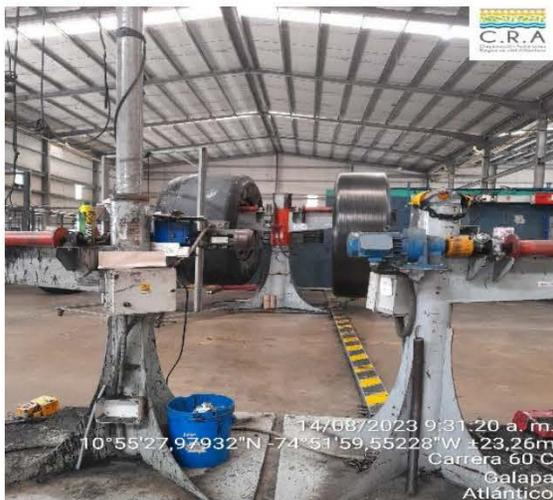
Foto 7: proceso de recauche de llantas mineras
